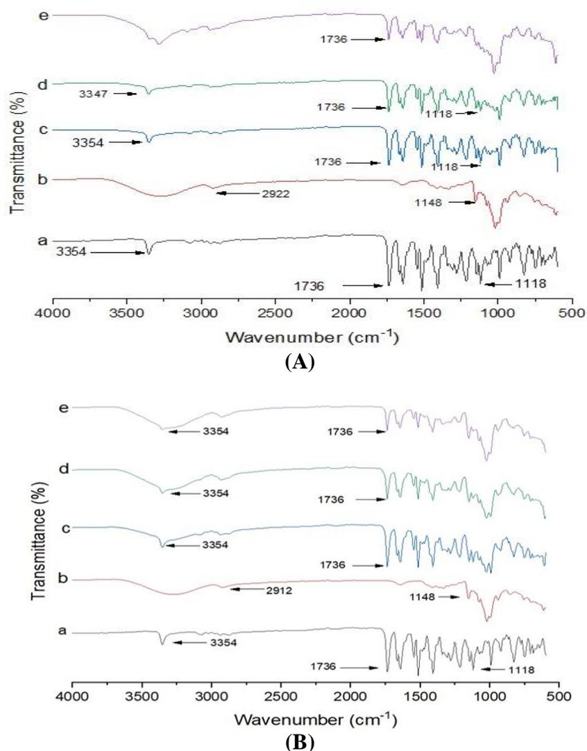
**Figure 4.** (A) FTIR Spectrum of (a) RIV, (b)  $\beta$ CD, (c) 1:1 RIV:  $\beta$ CD(KM), (d) 1:2 RIV:  $\beta$ CD (KM), (e) 1:4 RIV:  $\beta$ CD (K.M). (B) FTIR Spectrum of (a) RIV, (b)  $\beta$ CD, (c) 1:1 RIV:  $\beta$ CD (S.E), (d) 1:2 RIV:  $\beta$ CD (S.E), (e) 1:4 RIV:  $\beta$ CD (S.E).
